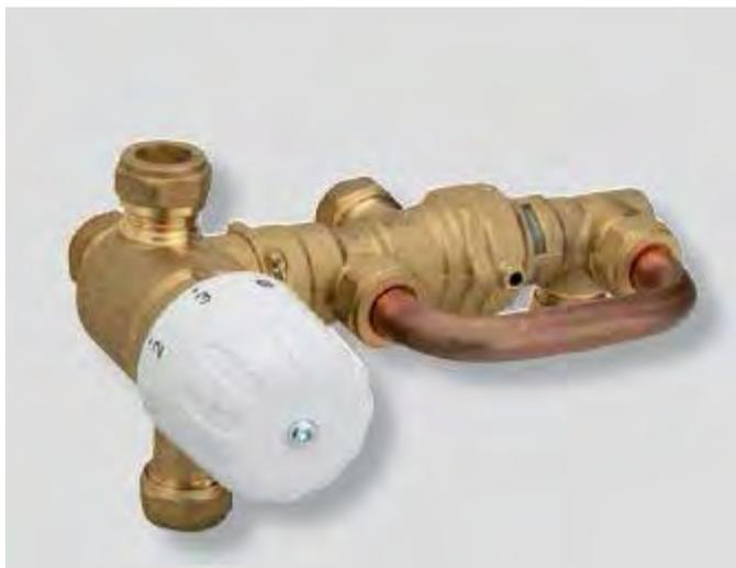
Термостатический клапан перекрывает проток воды через водонагреватель если на входе в него температура более  $48^{\circ}\text{C}$ .
