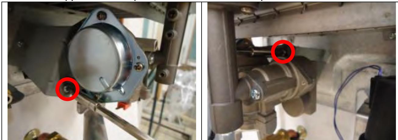
❖ Открутить 2 винта крепления газового коллектора
